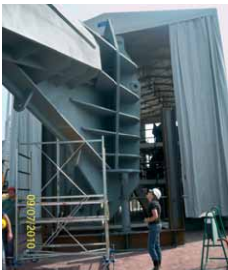
Fig. 34 - Nodo principale di appensione uscito dall'officina
