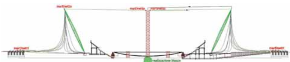
Fig. 40 - Sollevamento dei pennoni fino alla posizione verticale
